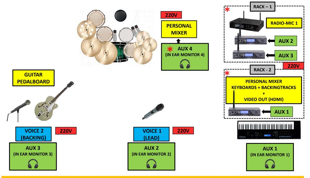
→ LONG XLR CABLES FROM P.A. REQUIRED FOR DRUMMER PERSONAL MIXERS (AUX4) AND (AUX1,AUX2,AUX3,RADIO-MIC1), BEHIND THE KEYBOARDS STATION → LONG HDMI CABLE FOR VIDEO PROJECTION: SOURCE OUTPUT FROM (RACK - 2)
